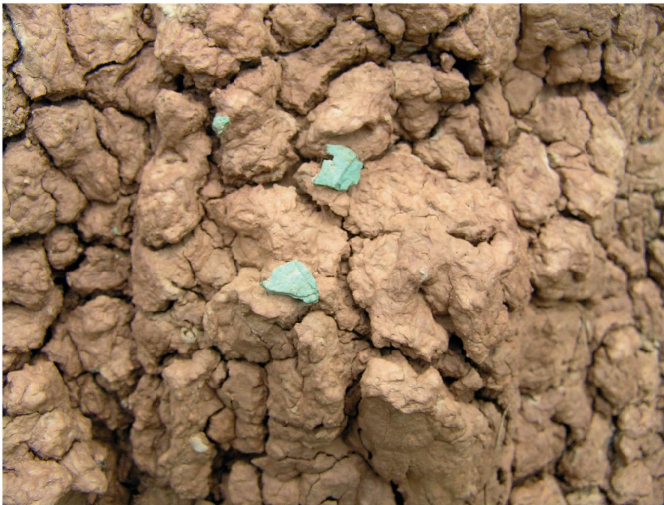
Figura 1 – Particolare degli inclusi di carbonato di rame ( $\text{CuCO}_3$ ) – ph Giuliano Cervi
